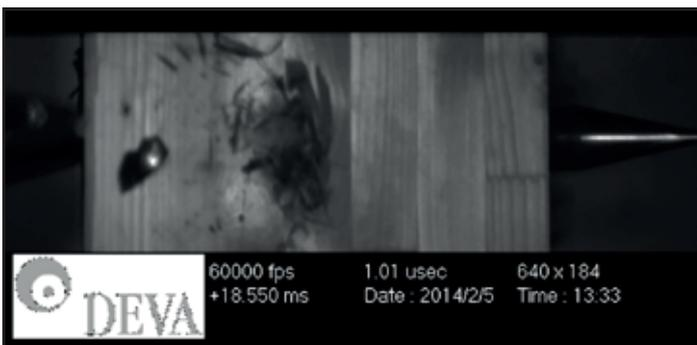
**Beschuss eines Vogelmodells mit einer Hochgeschwindigkeitskamera gefilmt. Rechts die den Vogelrumpf haltende Kegelmutter. Mitte links das austretende Projektil.**
